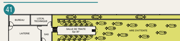
FIGURE 62 : VUE EN PLAN D'UN SYSTÈME DE TRAITE EN ÉPI 30° EN VACHES LAITIÈRES AVEC UN COULOIR DE RETOUR
